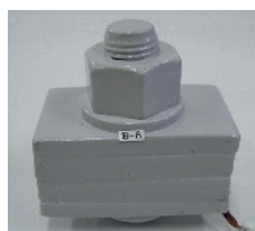
塗装 (鋼道路橋塗装・防食便覧 F11 塗装仕様)
