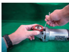
②カバー固定用リングを取付けます
