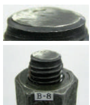
ピンテール破断面を研削したTCポルト
