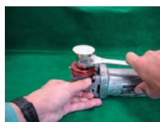
③専用研削刃を取付けます
