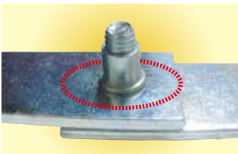
バルジ形成された締結後の裏面の状態
