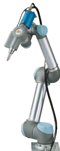
縦型エアリベッター + 協働ロボット
