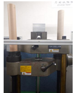
写真-2 試験体設置状況
