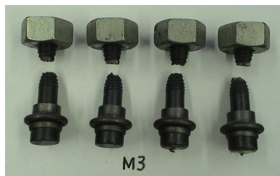
写真-8 引張試験後の破断状況 (M3)
