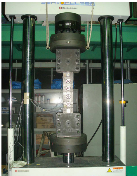
写真-2 疲労試験状況
