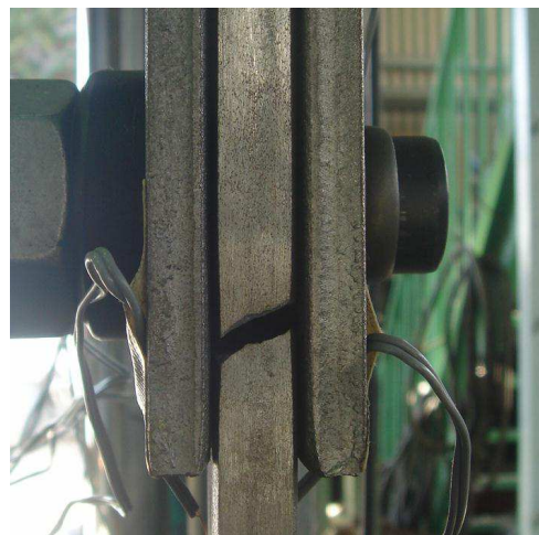
写真-4 母材破断状況 (M3)
