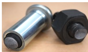
写真3 载荷後 引張試験体
