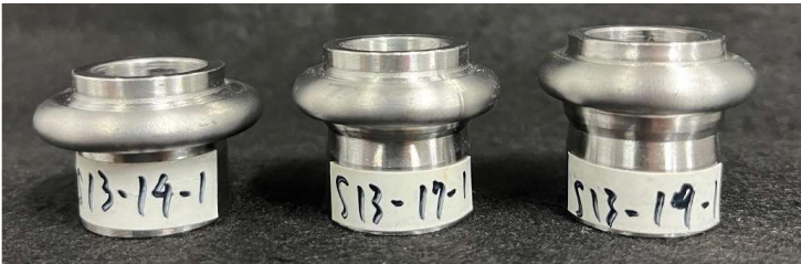
写真 1 載荷後の試験体 (S13, 左から板厚 14mm, 17mm, 19mm)
