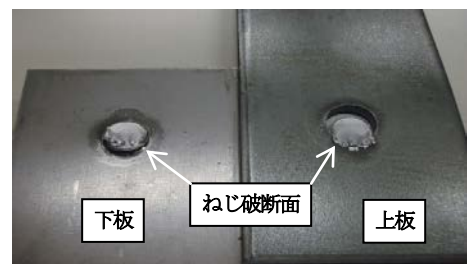
写真-3.4 ねじ径 \phi=10\text{mm} 、下板のねじ孔径 \phi=9.5\text{mm} 、板厚 t=4.5\text{mm} の破壊後の試験体
