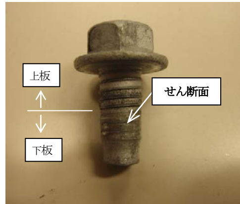
写真-2.3 ねじ径 \phi=10\text{mm} , 下板のねじ孔径 \phi=9.5\text{mm} , 板厚 t=4.5\text{mm} の試験片の破壊後のねじ
