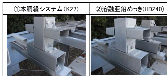
写真3. 屋外暴露試験体の外観写真
